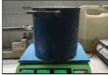
Gambar 18: Apparatus pemeriksaan berat isi beton basah.
