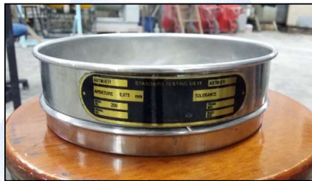
Gambar 11: Apparatus pemeriksaan bahan lolos saringan #200.
