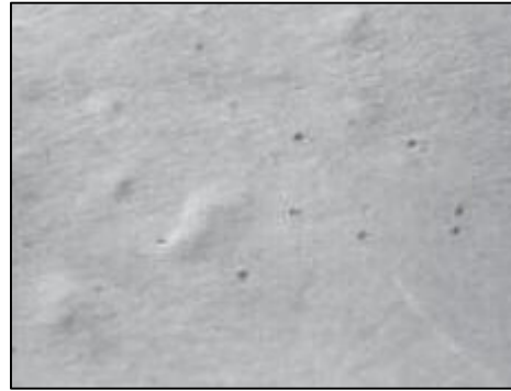
Gambar 5: Cacat beton bleeding , yaitu penguapan yang terjadi pada beton segar akibat penusukan yang berlebihan.
